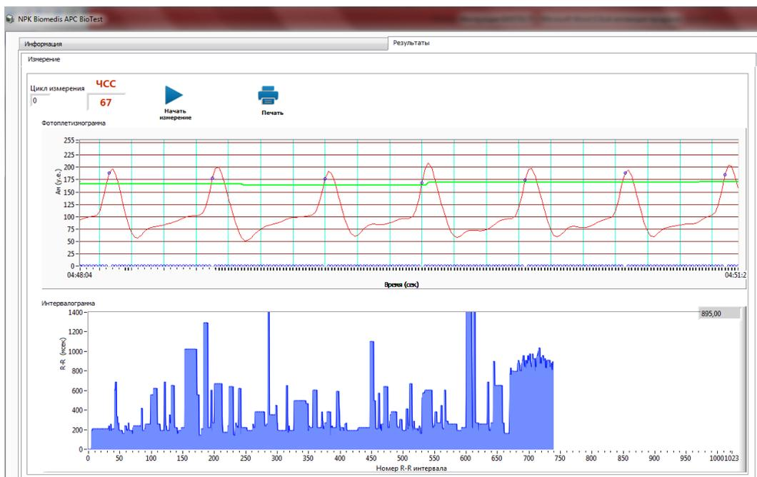
После стабилизации сигнала нажмите на кнопку «Начать измерение». Для набора необходимых данных для дальнейшего анализа программе необходимо 240 циклов измерения. Отсчет циклов отображается на индикаторе «Цикл измерения» на вкладке «Измерение». После 240 циклов активируются вкладки «Статистика», «Спектр», «Меридианы» и «Заключение».
